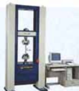
HT-2402 電腦伺服控制材料試驗機 Computer Servo Control Materials Testing Systems
